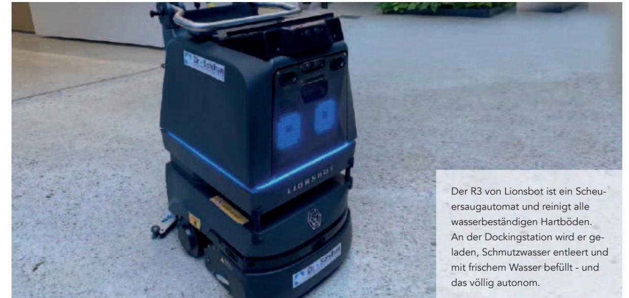
Der R3 von Lionsbot ist ein Scheuersaugautomat und reinigt alle wasserbeständigen Hartböden. An der Dockingstation wird er geladen, Schmutzwasser entleert und mit frischem Wasser befüllt - und das völlig autonom.
